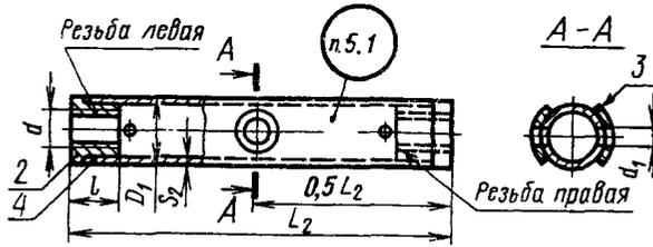
1 — струна; 2 — гайка; 3 — шайба; 4 — труба
